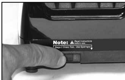
Figure 11. Nettoyage des disque de polissage (voir le texte).
